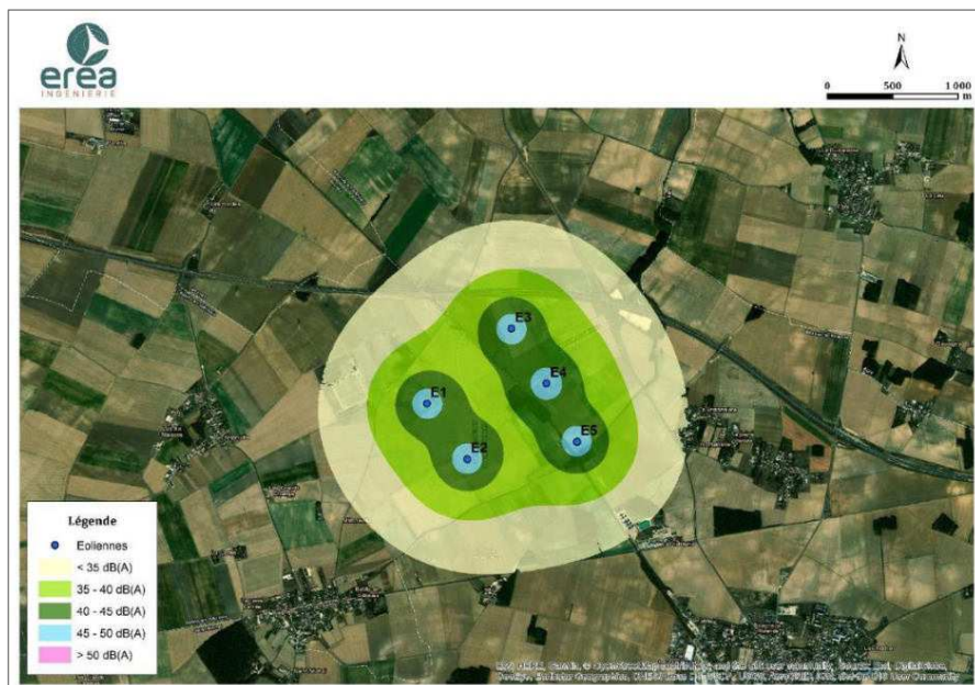
Figure 263 : Isophones pour l'implantation de 5 éoliennes de modèle E126 - 99 m pour un vent de vitesse standardisée de 5 m/s (Source : Etude acoustique d'EREA Ingénierie)
