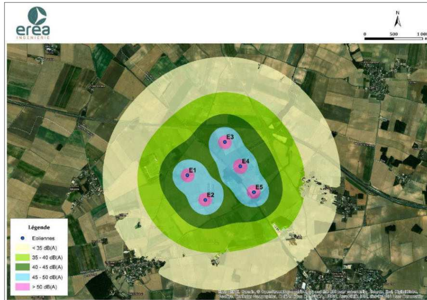
Figure 266 : Isozones pour l'implantation de 5 éoliennes de modèle E126 - 116 m pour un vent de vitesse standardisée de 10 m/s (Source : Etude acoustique d'EREA Ingénierie)
