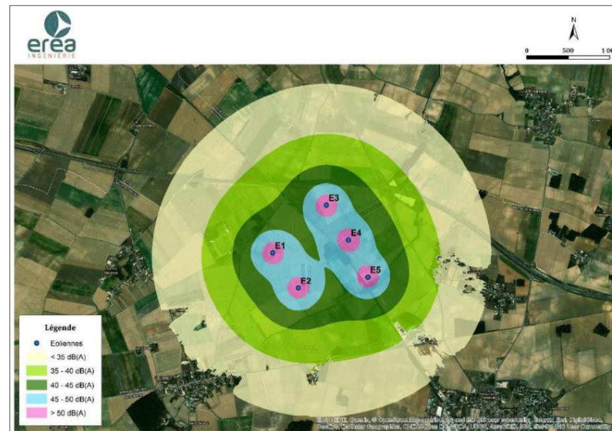
Figure 264 : Isophones pour l'implantation de 5 éoliennes de modèle E126 - 99 m pour un vent de vitesse standardisée de 10 m/s (Source : Etude acoustique d'EREA Ingénierie)
